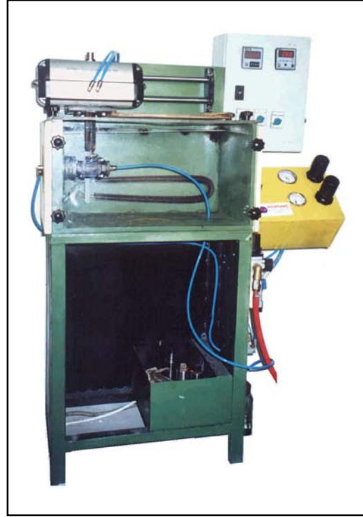
Gaz Küresel Vanaları Test İstasyonu
